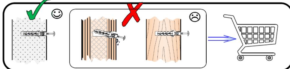
Pred montažo pohištva na steno ali pritrditve le-tega k steni (v cilju preprečitve, da se ne prevrne) prej preverite vrsto in močnost stene. Izberite vložke in vijake, ki odgovarjajo vrsti stene. V primeru dvomov se posvetujte s specialistom. Montažo sme opraviti izključno ustrezno kvalificirana oseba. **POZOR!!! Če so k izdelku priloženi razporni vložki z vijaki, so le-te namenjeni samo in izključno za montažo na stene, izdelane iz masivnih in homogenih materialov.**
