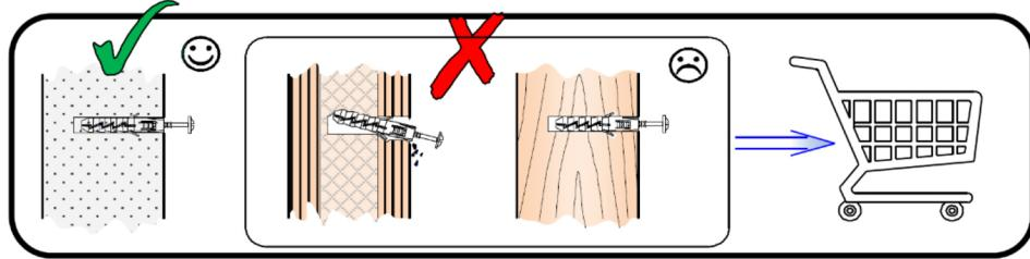
Pred montažo pohištva na steno ali pritrditve le-tega k steni (v cilju preprečitve, da se ne prevrne) prej preverite vrsto in močnost stene. Izberite vložke in vijake, ki odgovarjajo vrsti stene. V primeru dvomov se posvetujte s specialistom. Montažo sme opraviti izključno ustrezno kvalificirana oseba. **POZOR!!!** Če so k izdelku priloženi razporni vložki z vijaki, so le-ti namenjeni samo in izključno za montažo na stene, izdelane iz masivnih in homogenih materialov.
